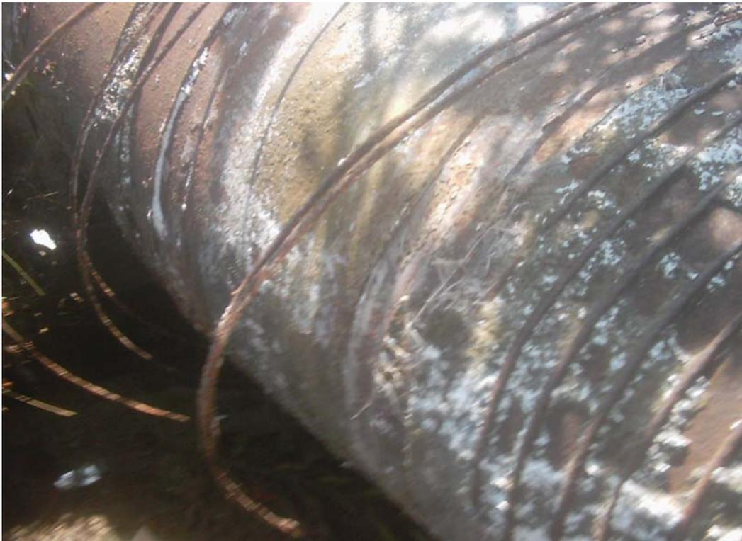
Foto 1, daños originados por difusión en una tubería de centro acero
